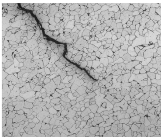
光学顕微鏡による亀裂観察(×100)
