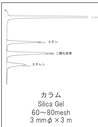
混合標準ガス分析結果クロマトグラム (キャリアーガス:アルゴン)
