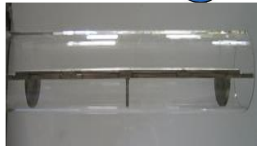
写真3 炉心管内にポートを挿入した状態
