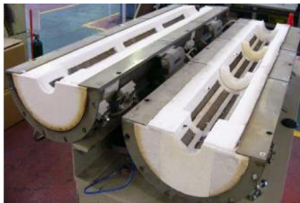
写真1 電気式環状加熱実験
