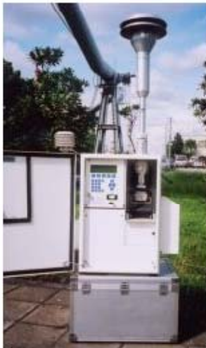
PM2.5ローボリュームサンプラー (米国連邦規格:FRM)
