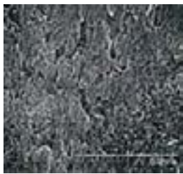
d. ねじり破壊破面
