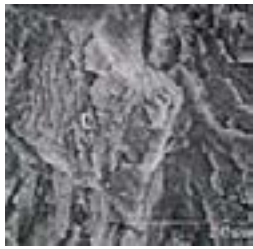
a. 疲労破壊破面
