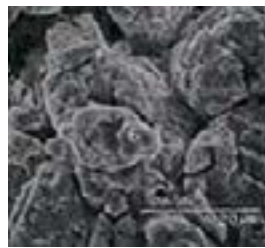
e. 腐食損傷破面
