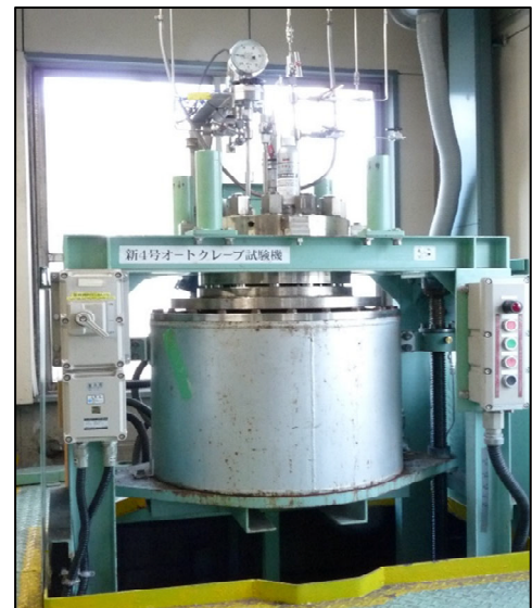
オートクレーブ装置外観
