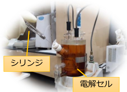
図2. 液体試料中の水分測定 (直接滴定法)
