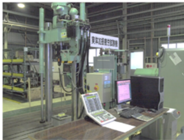
実体加振疲労試験装置外観
