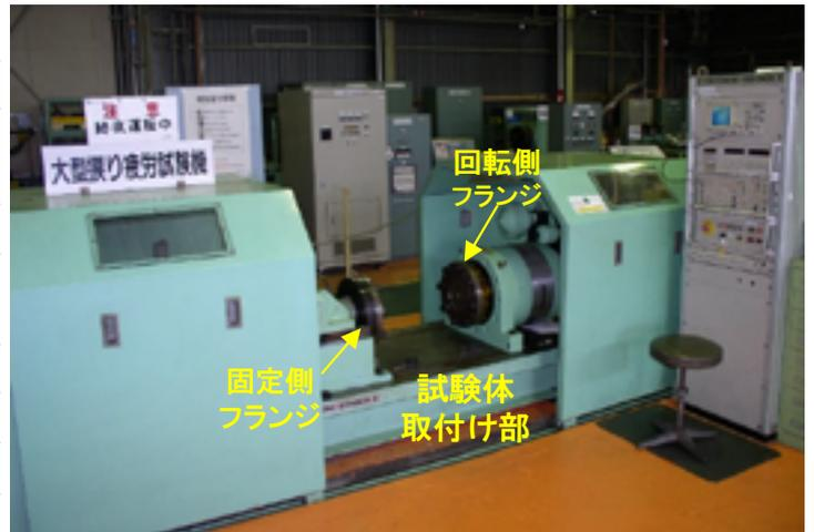
大型ねじり疲労試験装置の外観
