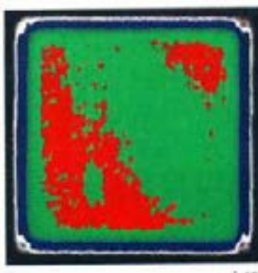
セラミックスと金属の接合面 (2mm x 17mm x 17mm)
