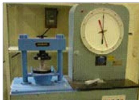
コンクリートコアの圧縮強度試験状況
