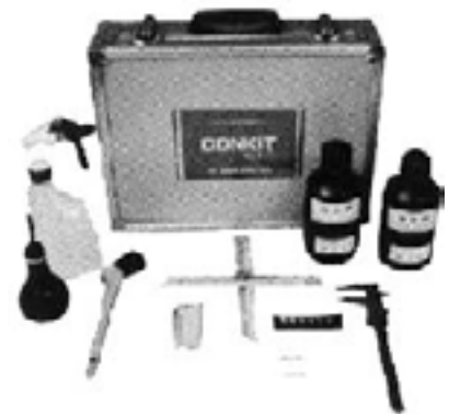
図2 中性化試験器具
