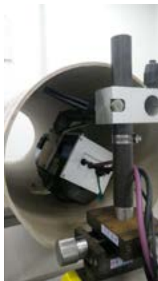
測定時の写真 左:引張試験中の応力測定 右:管の内壁応力測定
