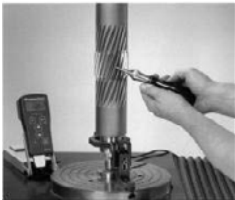
機械部品への超音波硬度計の適用例
