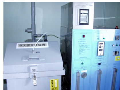
高濃度ガス腐食試験装置外観
