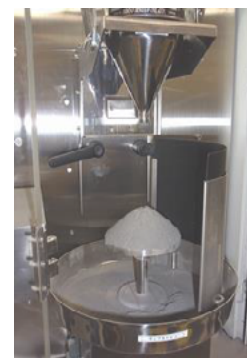
マルチテスタ(MT-1) による安息角測定
