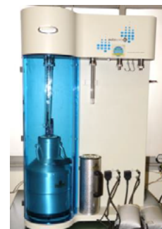
ガス吸着量測定
