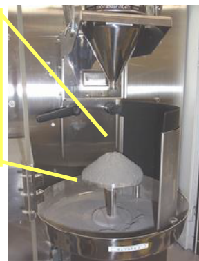
セイシン企業(株)製 マルチテスター(MT-1) による安息角測定
