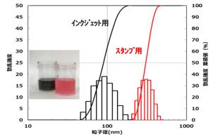
平均粒子径: インクジェット用・・・94nm スタンプ用・・・320nm
