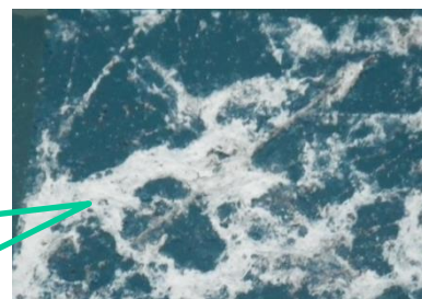
キャス試験後の塗膜材の表面写真
