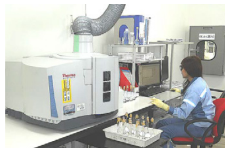
誘導結合プラズマ発光分光分析装置(ICP-AES) サーモフィッシャーサイエンティフィック(株)製 iCAP6300Duo
