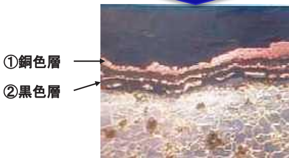
図4.赤銅色スケール断面拡大(x 200)
