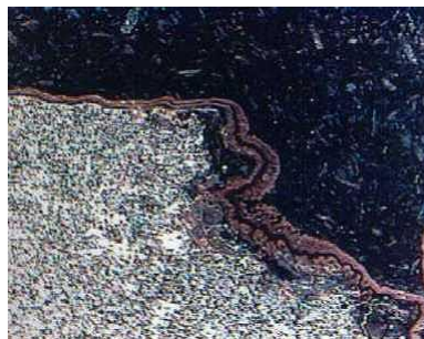
図3.赤銅色スケールの断面像(x 20)
