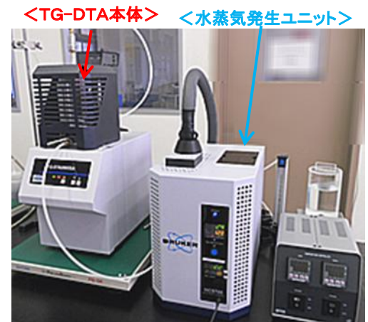
図4. 装置外観(TG/DTA2000SA)
