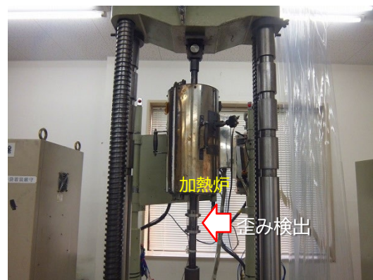
写真2 高温引張試験機 加熱炉拡大
