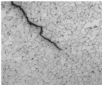
光学顕微鏡による亀裂観察(×100)
