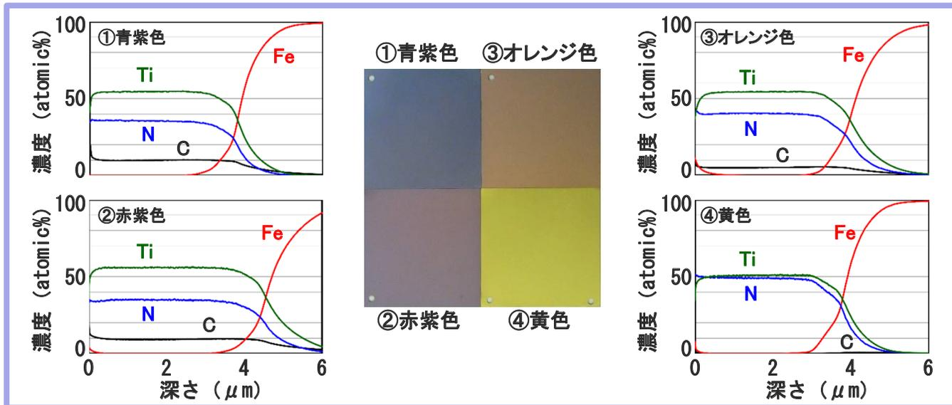
プロファイルを見ると表面からTi、NおよびCが検出されており、深い領域では基材のFeが検出されています。
