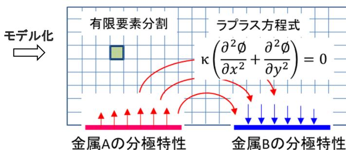
二つの電位の異なる金属A、Bを溶液中に浸漬し、Switch Onとした状態の実験イメージと数値解析イメージを示しています。
