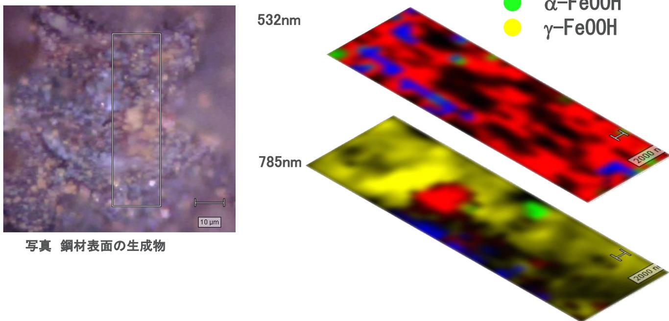
写真 鋼材表面の生成物
