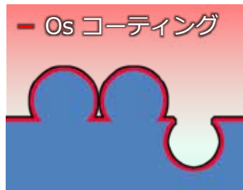
スパッタ蒸着法 vs Osコーティング法 (イメージ)
