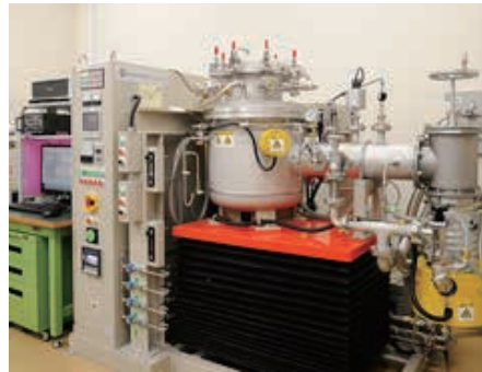
図1 自由共振法ヤング率・剛性率測定装置外観
