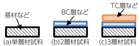
図4 多層解析用試験片形状
