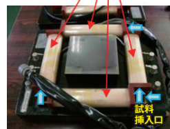
図5 エプスタイン測定枠(左)と試料の挿入方法(右)
