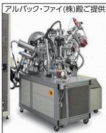
写真1 X線光電子分光(XPS)装置外観
