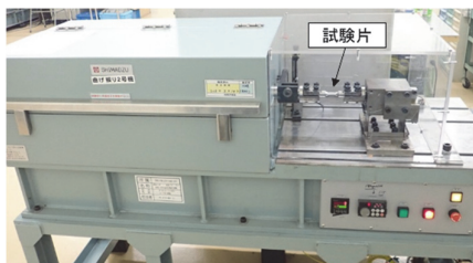
写真1 曲げ・ねじり疲労試験装置
