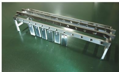
図2 短冊サンプルの例（一般的なサンプル寸法：W15×L25×t2 mm）
