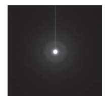
図8 界面層(水色枠)の電子回折図形
