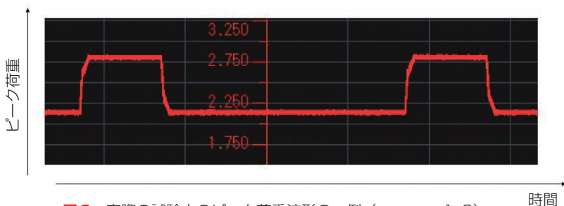
図2 実際の試験中のピーク荷重波形の一例 ( n_1 : n_2 = 1 : 3 )
