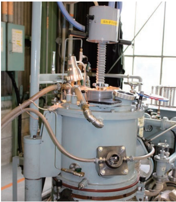
図1 ボタン溶解炉の外観
