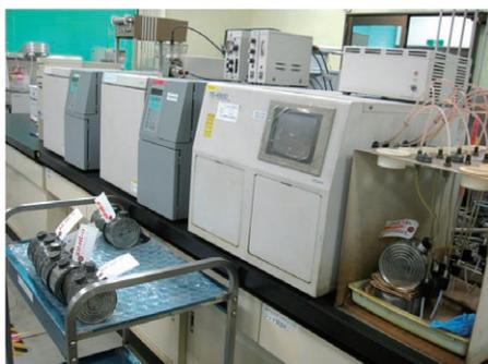
図1 油中ガス分析装置
