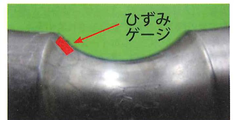
図1 ひずみゲージ貼付状況
