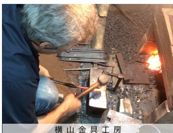
太宰府天満宮末社志賀社本殿に適用された REI-和-TETSU でつくられた金具の製作・取付状況
