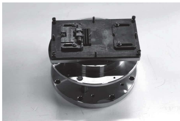
図5 MFT-5000のXYステージと組み合わせることで等速往復動試験が可能な治具
