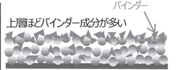
図6 SAICASによる正極材のマイグレーション評価結果
